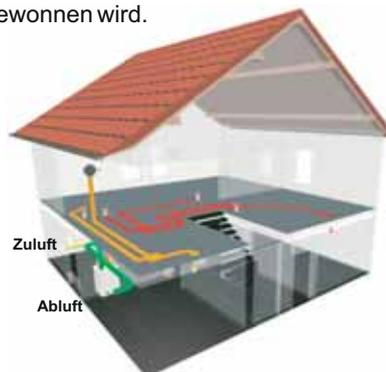
**Wärmerückgewinnung im Kreuzstromwärmetauscher**
